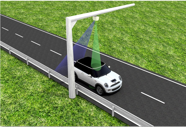
Tespit bölgeleri : radar (mavi) ve ultrasonik (yeşil)
